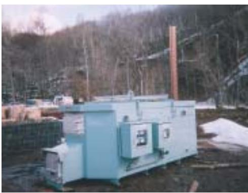
移動式炭窯は、内容積3m<sup>3</sup>の炭窯で、炉内温度を連続的に計測し記録することが出来る。炉内温度分析することで炉内温度と木炭の特性の相関関係を把握して、用途に合った木炭を生産することが可能になる。
